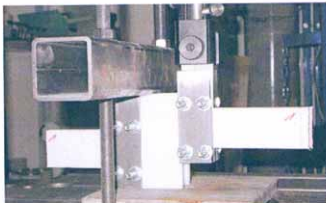
Versuch bei der maximalen Auslenkung von 15 mm
